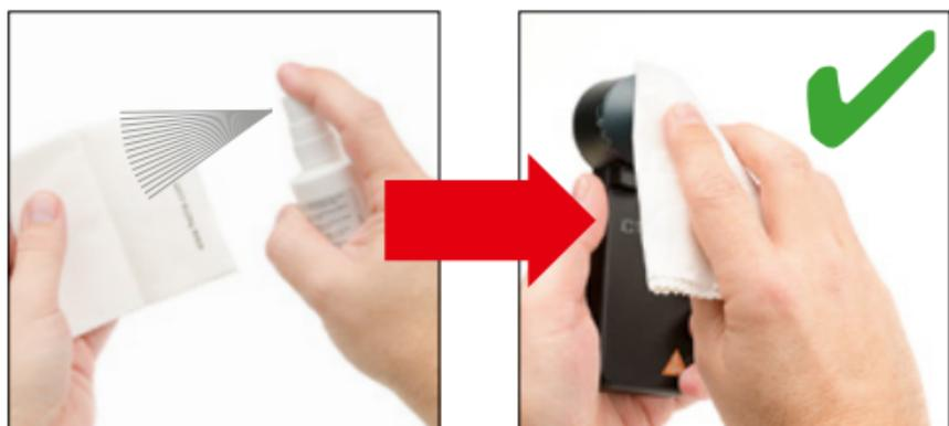
Les produits désinfectants et nettoyeurs ne doivent jamais être pulvérisés directement sur l'embout de contact et ce afin de prévenir et d'éviter tout dommage de l'appareil.
