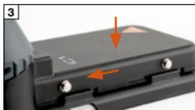
Insertion de la coque d'adaptation sur le HEINE iC1, jusqu'à enclenchement de ce dernier.
