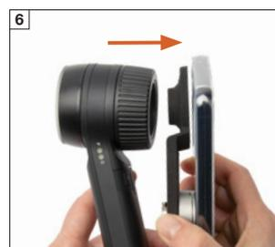
El imán del adaptador sujeta ahora el teléfono móvil junto con el soporte sobre el anillo de enfoque del dermatoscopio.
